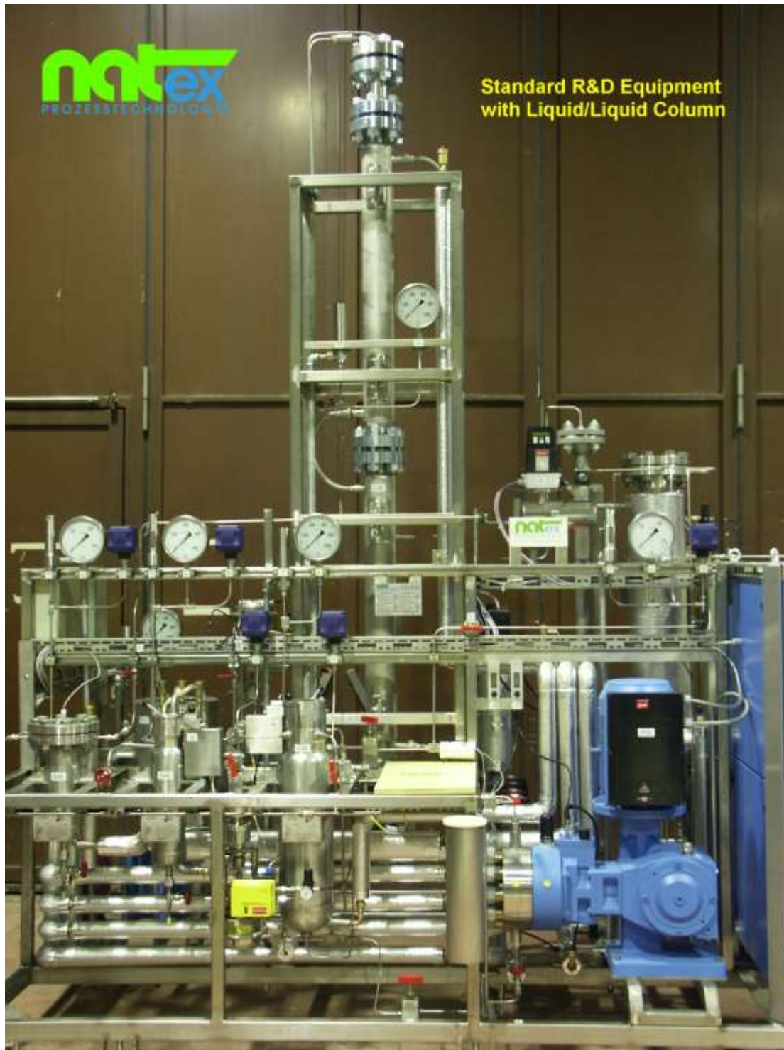
Abbildung 3: Kohlendioxidhochdruckextraktionsanlage an der Fachhochschule Lübeck
