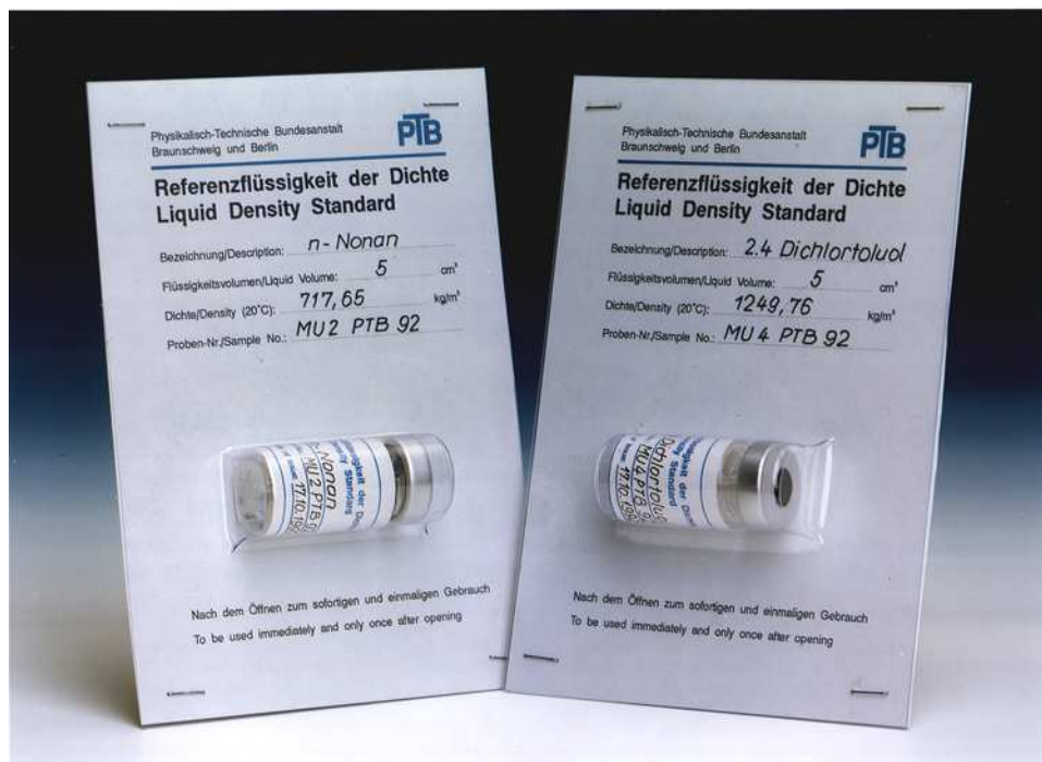
Abb. 11. Konfektionierte Dichte-Referenzflüssigkeiten der Physikalisch-Technischen Bundesanstalt zur Kalibrierung von Schwinger-Dichtemessgeräten
